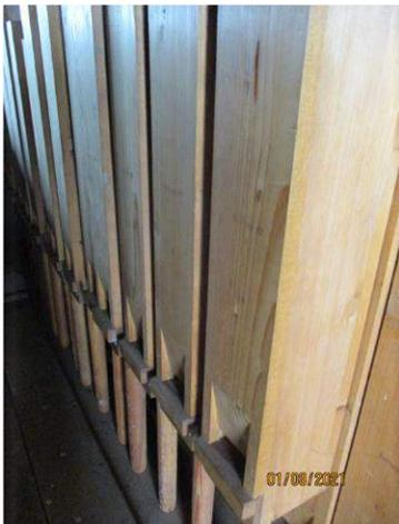
Orgelpfeifen werden aus Holz oder Metall (verschiedenartige Zinn-Blei-Legierungen) hergestellt. Man unterscheidet Labialregister mit einem der
