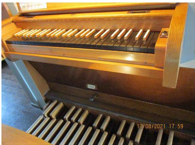
trumenten wird die Bewegung der Tasten des Manuals oder des Pedals über die Traktur zu den Ventilen der Windlade weitergeleitet. Die Traktur besteht aus den Abstrakten aus Holz oder Draht und den
